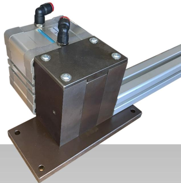
Pneumatische Schneidevorrichtung für Drahtseile
